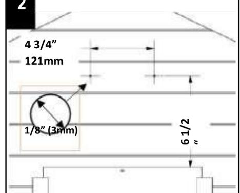
Markieren Sie zwei Lochpositionen 4 3/4" (121 mm) voneinander entfernt, ungefähr 6 1/2" (170 mm) über der Oberseite der Schiebetür. Achten Sie darauf, dass sie eben und in gleich-mäßigem Abstand über der Mitte der Tür liegen. Machen Sie die Löcher mit einem 1/8" (3,0 mm) Bohrer oder einer Zange.
