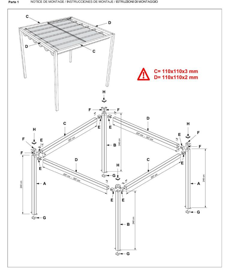
Deel 1 PERGOLA CONSTRUCTIE / PERGOLA CONSTRUCTION / PERGOLA BAUKASTEN / PERGOLA AUTOPORTANTE / Part 1 CONSTRUCCIÓN DE PÉRGOLA / COSTRUZIONE DELLA STRUTTURA
